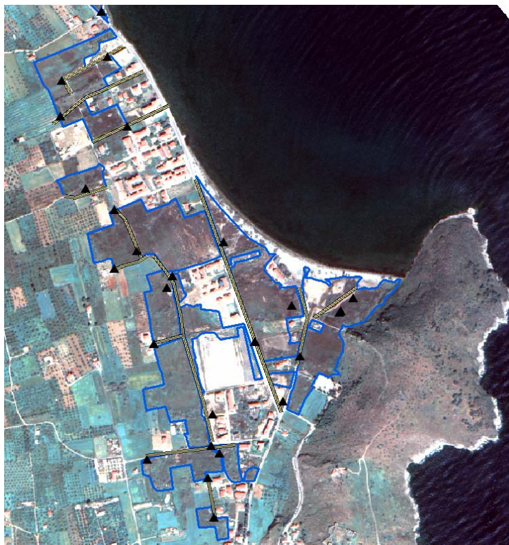
Εικόνα 3: Υγρότοπος Περιοχής Ατσιγγανού (όριο με μπλε γραμμή): Τομές (μαυρο-κίτρινες γραμμές) και σημεία ελέγχου (μαύρα τρίγωνα).
